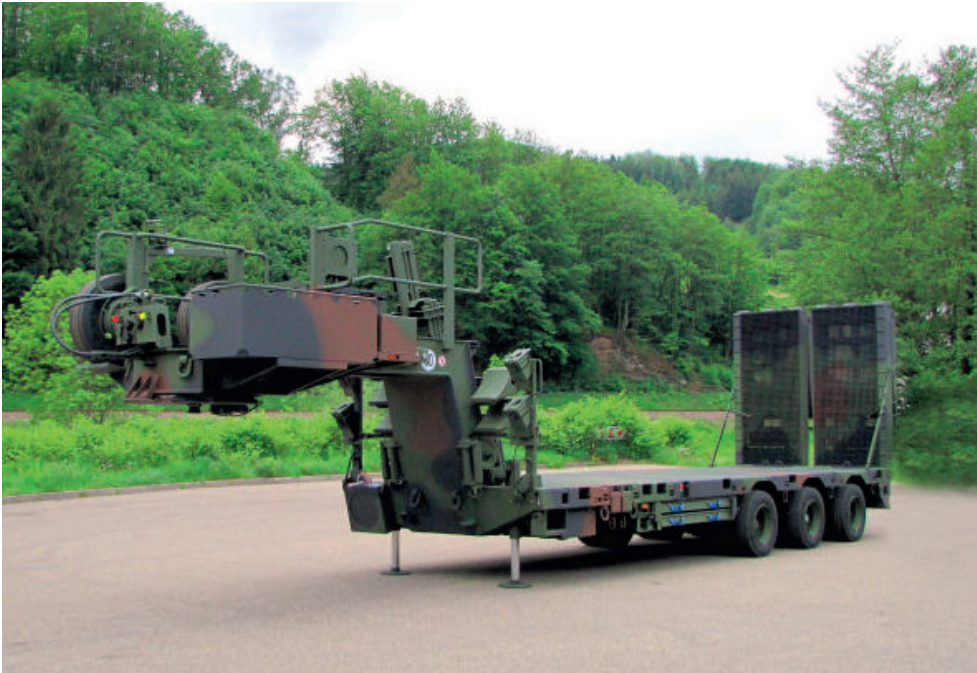
Rys. 4. Widok naczepy terenowej – wysoko prowadzona zabudowa sprzęgu umożliwia uzyskiwanie wysokich parametrów ruchu w warunkach terenowych
