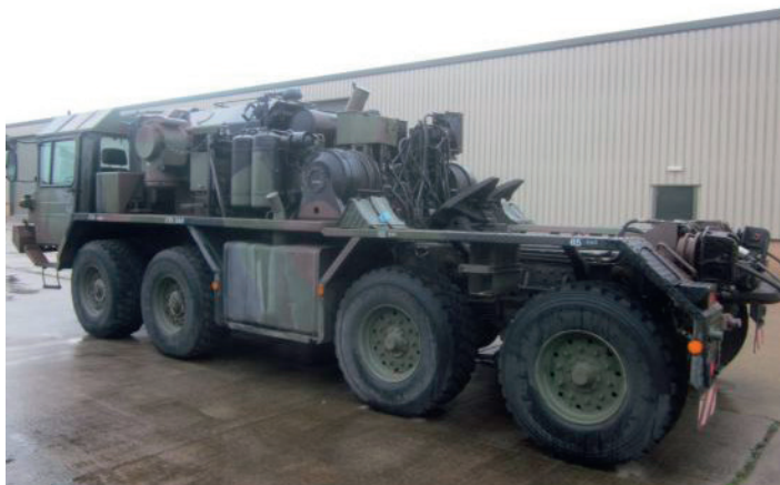
Rys. 5. Widok ciągnika siodłowego wyposażonego w siodło o dwóch stopniach swobody
