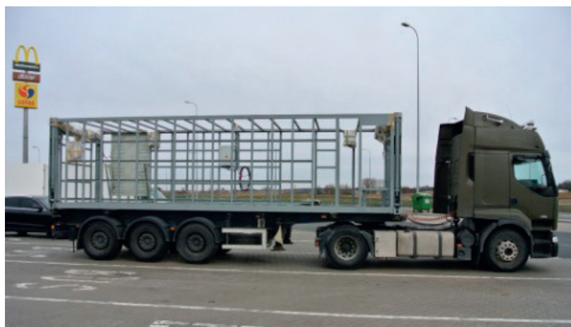
Rys. 2. Widok podwozia używanego w trakcie projektu – pierwsze próby trakcyjne ze szkieletem kontenera Źródło: wme.wat.edu.pl.
