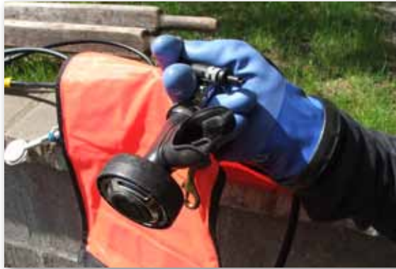
Ryc. 174. Uchwyt zawór i węża automatu jedną ręką
